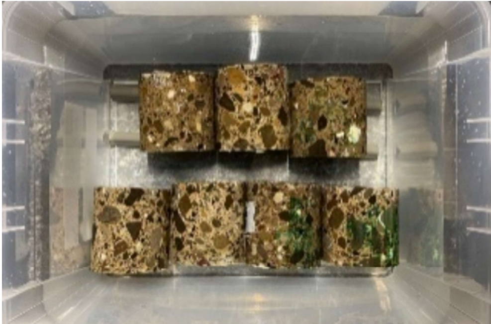
Abb. 30 Probenvorbereitung, Beschichtung und Lagerungsschema (oben) sowie Fotos der Lagerung am SUPSI (unten)
