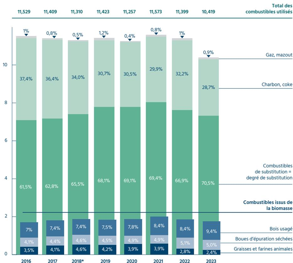
En 2023, 70,5 % de l'énergie nécessaire a pu être obtenue à partir de combustibles de substitution. L'industrie du ciment peut ainsi fournir d'importantes prestations en matière d'élimination et de valorisation des déchets.
