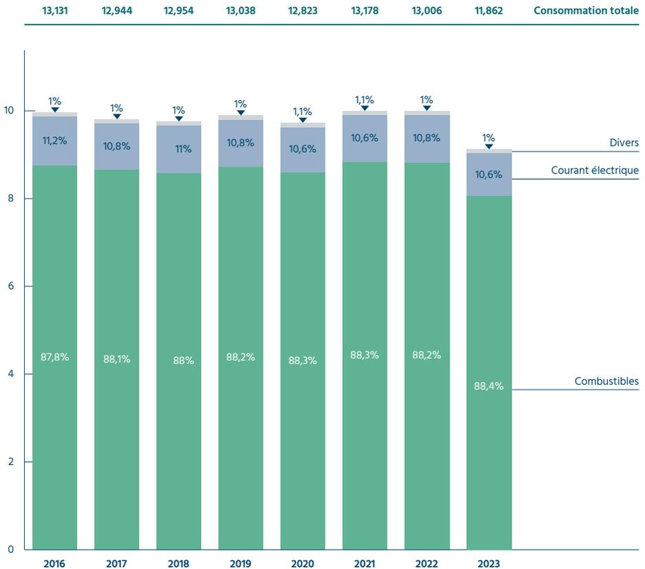
La consommation totale d'énergie de l'industrie suisse du ciment a légèrement diminué, de 13,006 à 11,862 pétajoules. La répartition entre l'électricité et les combustibles est restée dans l'ensemble constante.
