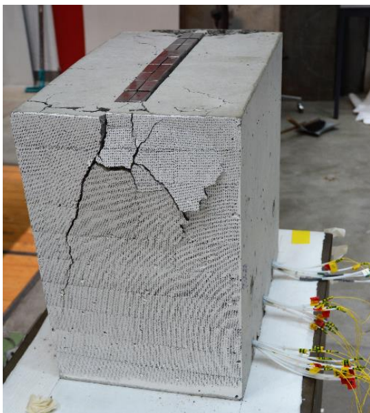
Bild – Experimentelles Programm: (a) Versuche an teillächenbelasteten Stahlbetonblöcken; (b) Versuchskonzept für Betongelenke im Large Universal Shell Element Tester (LUSET) an der ETH Zürich.
