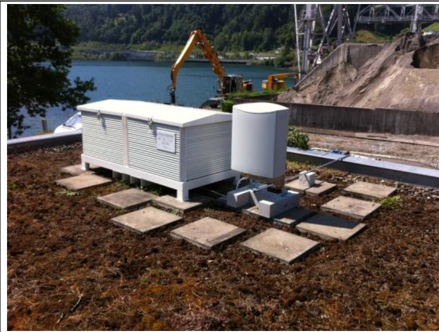
Abb. 1: Stevenson-Screen in Horw mit Messkasten für die unbewitterte Aussenlagerung von Betonprüfkörpern.
