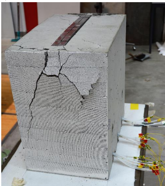
Bild – Experimentelles Programm: (a) Versuche an teilflächenbelasteten Stahlbetonblöcken; (b) Versuchskonzept für Betongelenke im Large Universal Shell Element Tester (LUSET) an der ETH Zürich.
