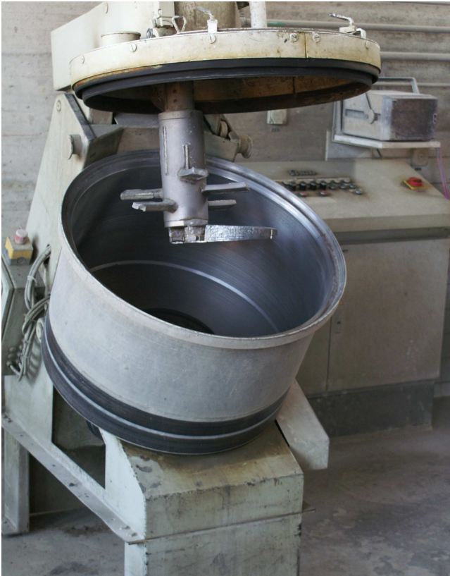
Abbildung 5: Für die Betonherstellung verwendeter Eirich-Mischer (maximales Fassungsvermögen: 80 Liter).
