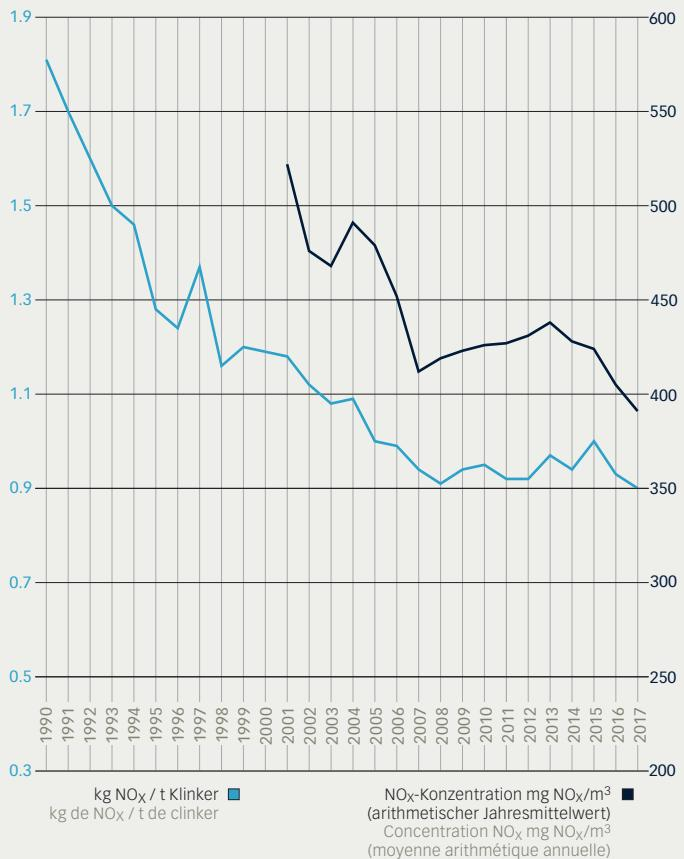
Die revidierte Luftreinhalteverordnung (LRV) sieht für die spezifischen NO<sub>x</sub>-Emissionen einen Grenzwert von 500 mg/m<sup>3</sup> vor. cemsuisse hat sich im Rahmen der NO<sub>x</sub>-Branchenvereinbarung zu einer freiwilligen Reduktion auf 400 mg/m<sup>3</sup> für die gesamte Industrie verpflichtet und ist auch in Zukunft bestrebt, weitere Reduktionen zu erzielen.
